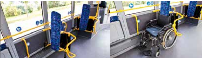
Einsatz einer Prallplatte als Rollstuhlsicherung
