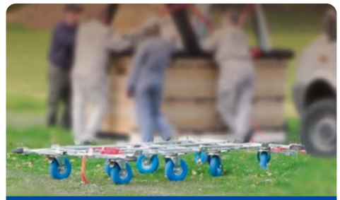
Fahrgestell für schwere Ballonkörbe
