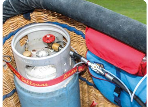
Sicheres Ableiten des austretenden Gases
