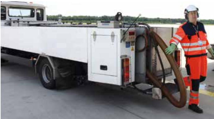
Rutschhemmender Aufstieg aus Gitterrost
