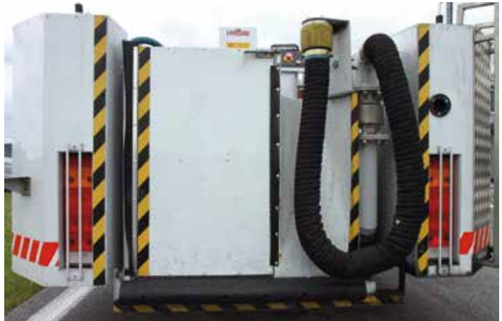
Hubplattform mit Kennzeichnung und Abweisern
