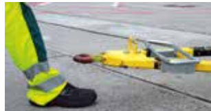
Zuggabel mit Bodenfreiheit \geq 120 mm
