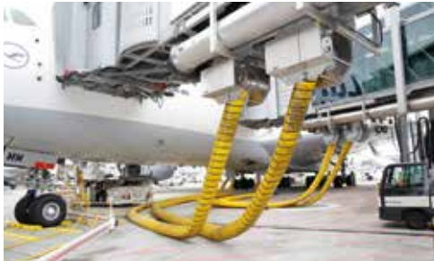
Stationäre Versorgung eines Luftfahrzeuges
