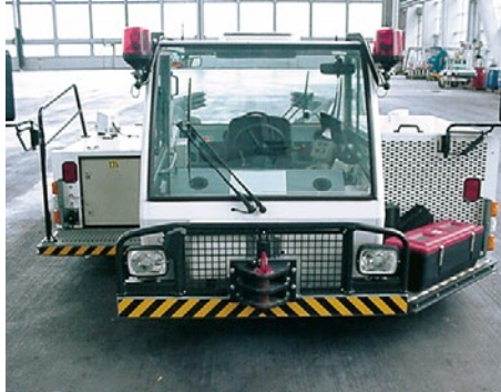
Lichttechnische Einrichtung für beide Fahrrichtungen
