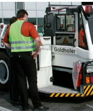
Kennzeichnung von exponierten Stellen
