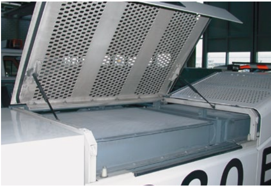
Zwei Gasdruckdämpfer sichern die offene Klappe
