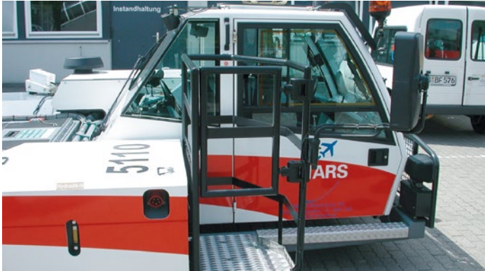
Geländer als Absturzsicherung am Mitfahrerplatz
