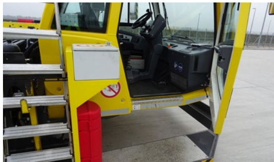
Ausreichend dimensionierte Trittstufe
