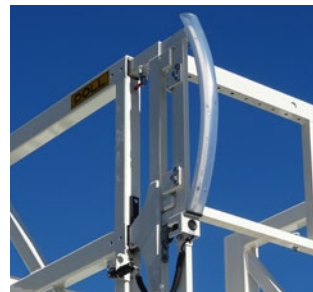
Abstandssensor am Klappgeländer
