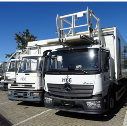
Catering-Hubfahrzeug mit Fullsize-Plattform
