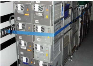
Gesicherte Ladung im Kofferaufbau
