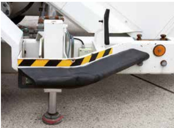
Gefahrstelle an einer Abstützeinrichtung
