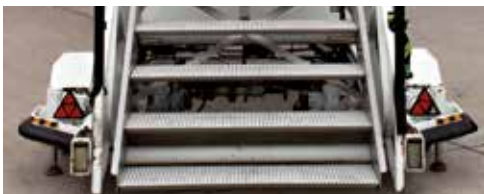
Lichttechnische Einrichtung an einer schleppbaren Treppe
