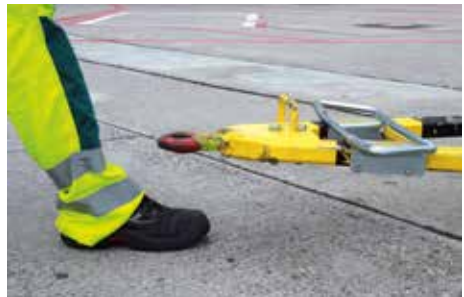
Zuggabel mit Bodenfreiheit \geq 120 mm
