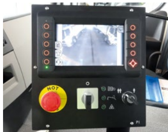
Am Heck montierte Kamera und Monitor im Führerhaus
