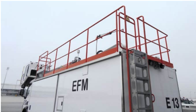
Geländer als Absturzsicherung
