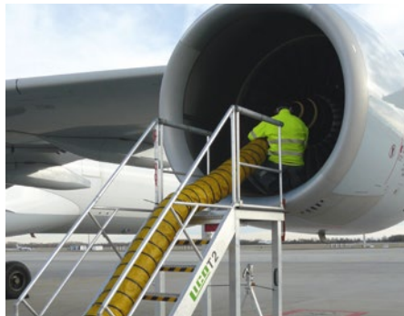
Triebwerksenteisung mit Heizgerät
