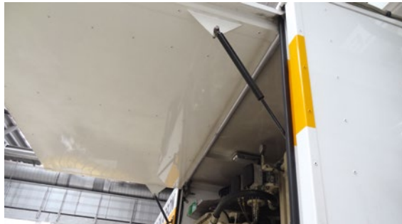
Klappe mit zwei Gasdruckfedern
