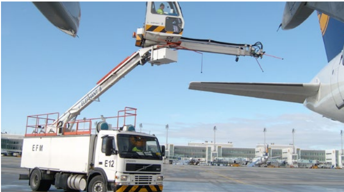
Enteiser mit Fahrer im Führerhaus und Bediener in Bedienerkabine
