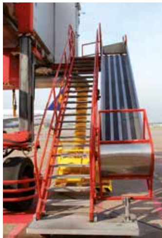
Außentreppe an Fluggastbrücke
