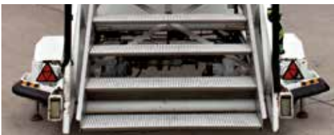
Lichttechnische Einrichtung an einer schleppbaren Treppe
