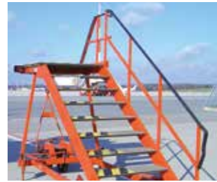
Treppe mit unvollständigem Geländer
