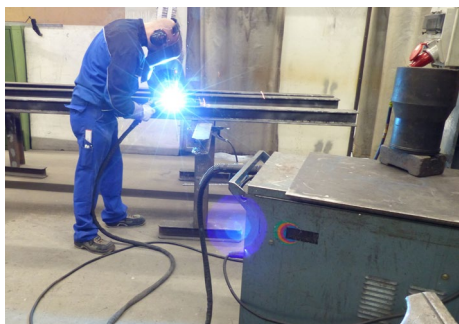
Abb. 9 Hohe mechanische und thermische Einwirkungen auf die Anschlussleitung des Elektroschweißgerätes
