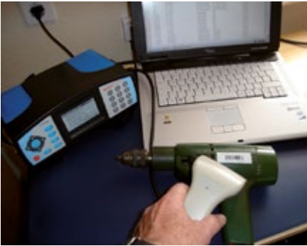
Bild 3: Rechnergestützter Prüfplatz mit Barcode-Scanner
