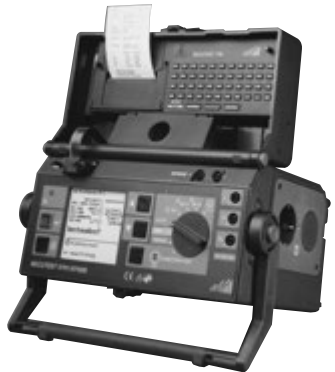
Bild 2: Universalprüfgerät mit Speicher- und Druckfunktion
