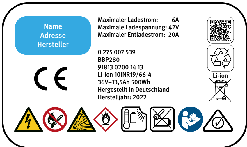
Abb. 6 Beispiel eines Typenschilds einer LIB
