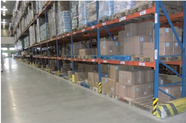
Abb. 19 Stützenschutz an allen Stützen
