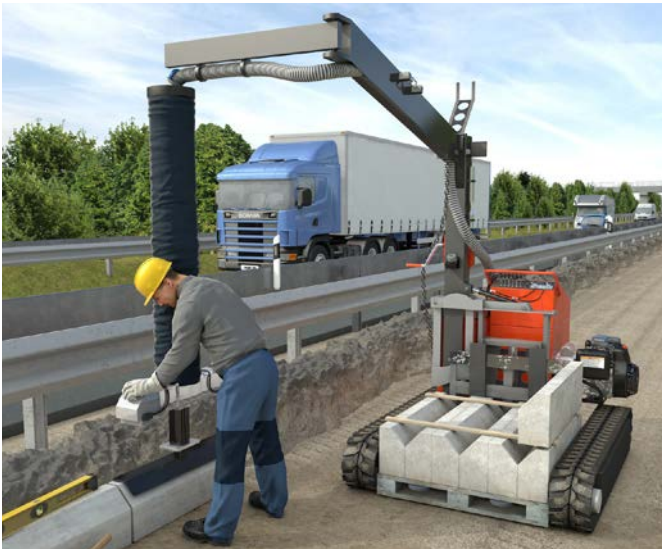
Abb. 14 Vakuum- und pneumatische Hebehilfen
