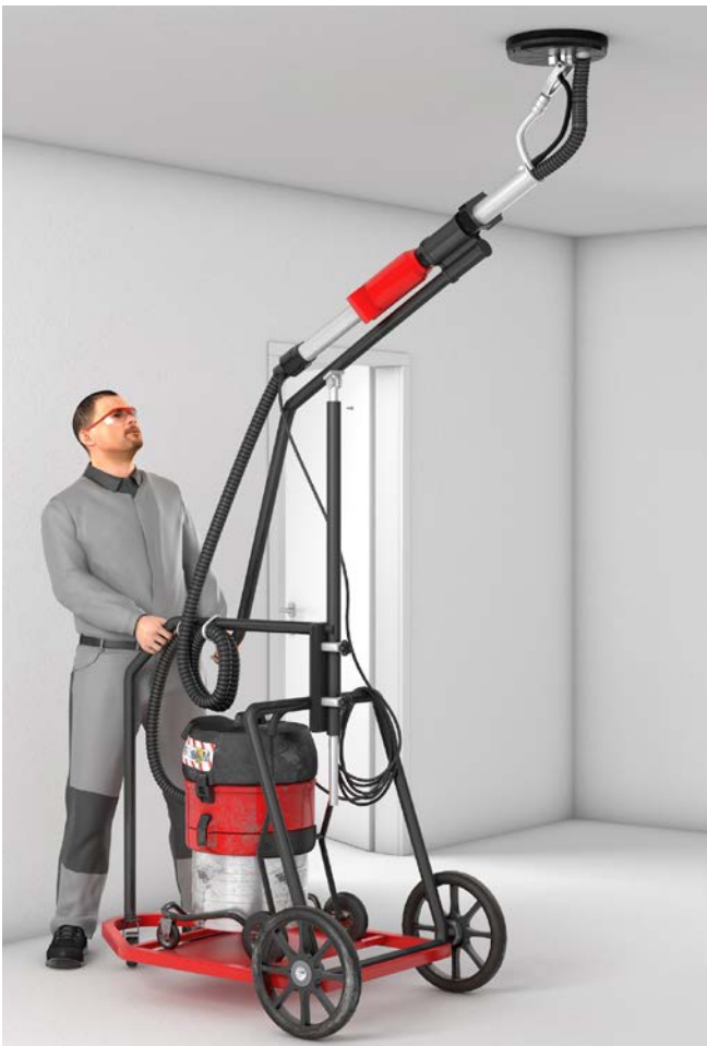
Abb. 22 Die Belastungen für Schulter und Arme werden mit einem Führungswagen für Langhalsschleifer durch das Wegfallen der Haltearbeit deutlich reduziert.
