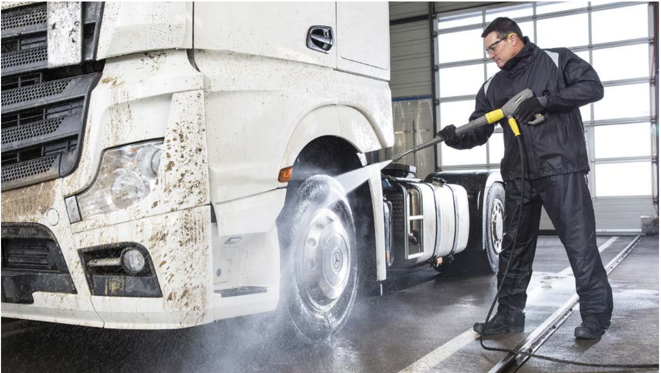
Abb. 17 Sichere Verwendung handgeführter Hochdruckreiniger
