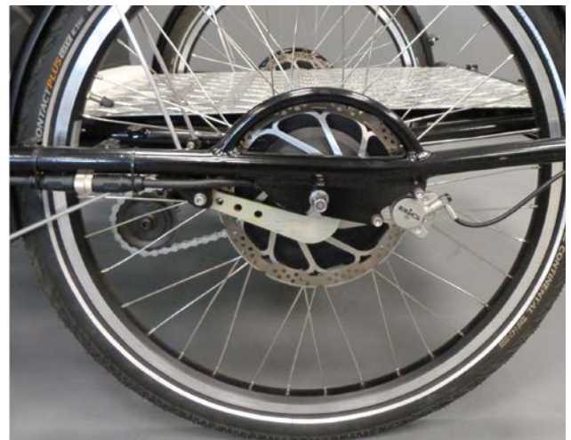
Abb. 25 Nabenmotor im Hinterrad
