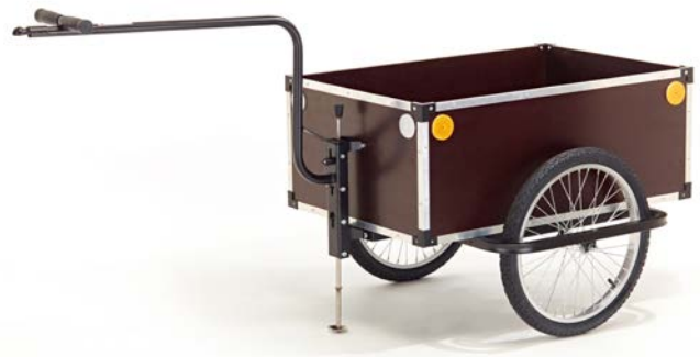
Abb. 32 Zweispuriger Fahrradanhänger mit Hochdeichsel
