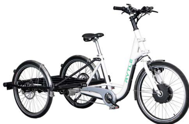
Abb. 7 Zweispurig, Laufradpaar hinten
