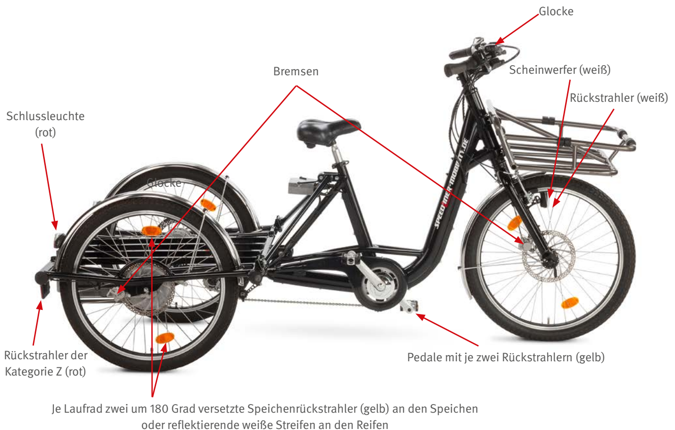
Abb. 1 Vorgeschriebene Ausstattung des Lastenrades
