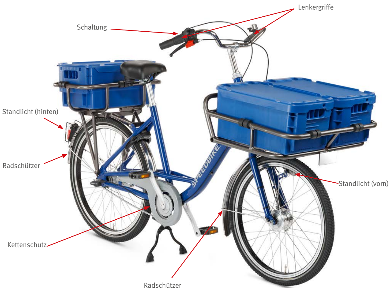
Abb. 20 Empfohlene Zusatz-Ausstattung des Lastenrades
