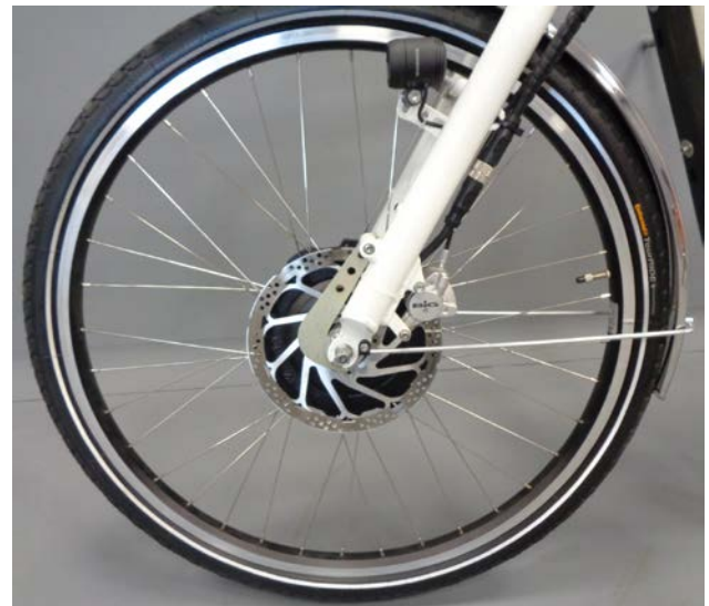
Abb. 23 Nabenmotor im Vorderrad
