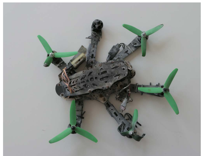
Abb. 18 Multikopter nach einem Akkubrand
