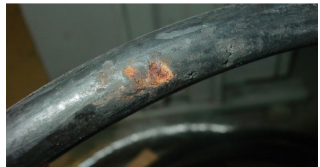
Abb. 10.1 Defekte Hydraulik-Schlauchleitungen sofort ersetzen
