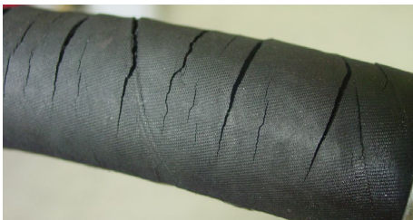
Abb. 10.1 Defekte Hydraulik-Schlauchleitungen sofort ersetzen
