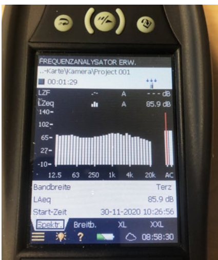
Abb. 22 Terz-Frequenzanalyse mit der Software des Messgeräts
