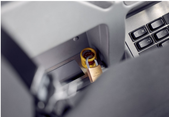
Abb. 4 Beispiel für das Sichern gegen Wiedereinschalten
