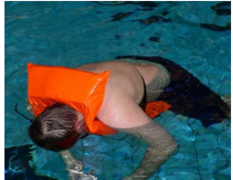
Abb. 8 Mögliche gefährliche Ohnmachts- lage mit Feststoffweste 100 N Auftrieb
