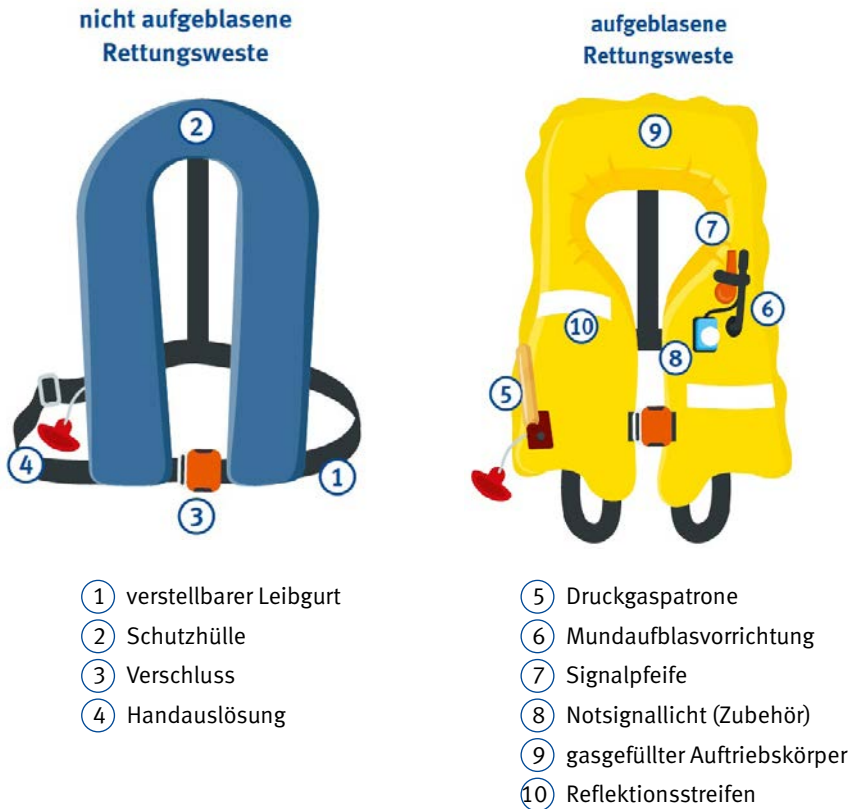
Abb. 10 Nicht aufgeblasene und aufgeblasene Rettungsweste
