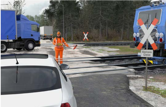
Abb. 19 Durch die Warnkleidung ist der Bahnübergangsposten für den Straßenverkehr gut erkennbar.
