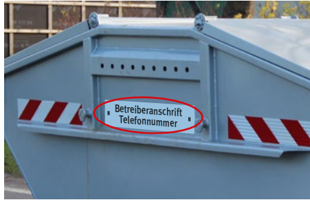
Abb. 26 Absetzbehälter mit Sicherheits- kennzeichnung
