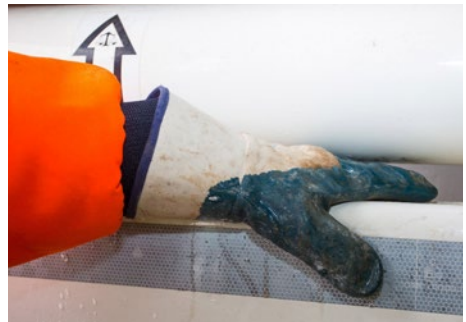
Abb. 24 Quetschstelle zwischen Zylinder und Rahmen
