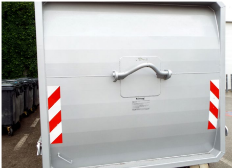
Abb. 24 Rangierbügel an der Tür der mobilen Behälterpresse
