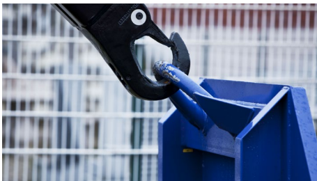
Abb. 7 Hakenausleger mit hydraulischer/ pneumatischer Sicherung
