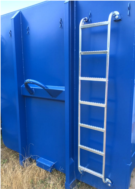
Abb. 30 Sicher begehbarer Aufstieg am Behälter
