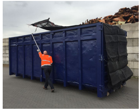
Abb. 37 Manuelles Abdecksystem mit einer Stange und Laufrad
