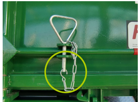
Abb. 29 Gesicherter Verschluss am Abrollbehälter
