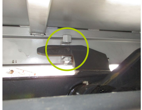
Abb. 14 Verriegelungsdorn und Verriegelungsöse
