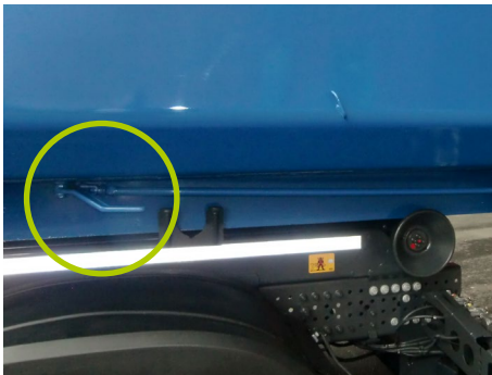
Abb. 28 Zentralverschlusshebel sollte von der Tür in einem Abstand von 1750 mm angebracht sein
