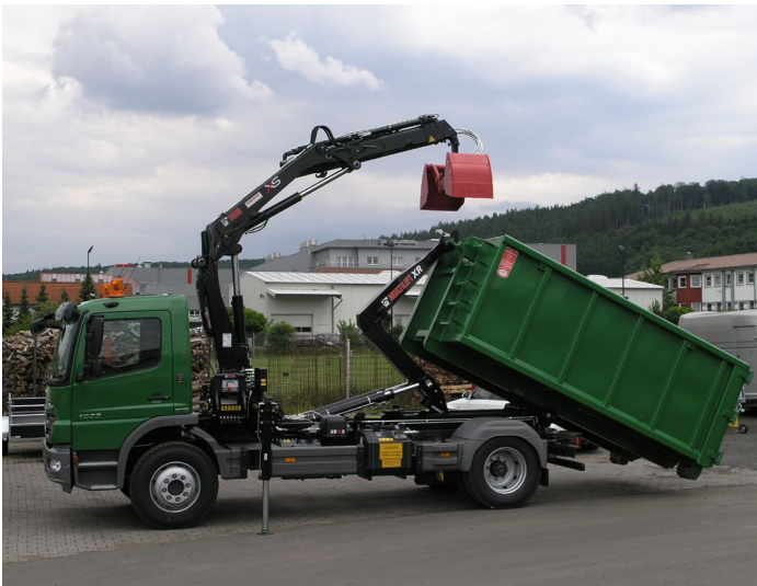
Abb. 18 Abrollkipper mit Lkw-Ladekran
