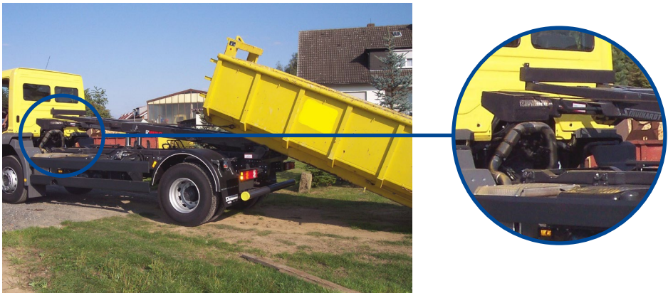
Abb. 19 Kipprahmen mit Seilwinde
