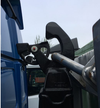
Abb. 13 Aufnahmehaken und Aufnahmebügel
