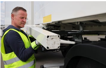
Abb. 8 Stützbein mit Stützbeinstrebe mit beiden Händen herausziehen
