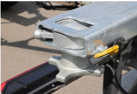
Abb. 14 Stellung der Fallsicherung gegen Rückfall
