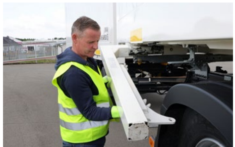
Abb. 9 Stützbein mit Stützbeinstrebe herabschwenken
