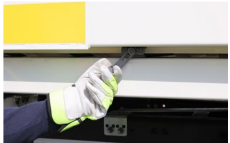
Abb. 7 Lösen der Transportsicherung (Fallsicherung)
