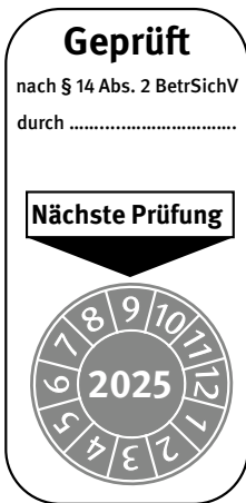
Abb. 29 Beispiel einer Prüfplakette
