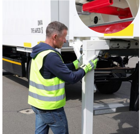
Abb. 13 Stützbeinverriegelung einrasten lassen und Verriegelung kontrollieren
