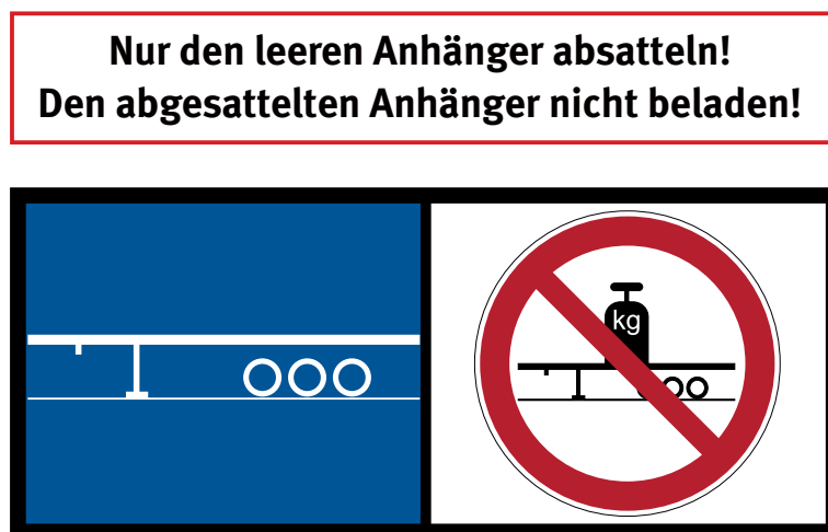
Abb. 26 Kennzeichnung an Sattelstützen geringerer Tragfähigkeit
