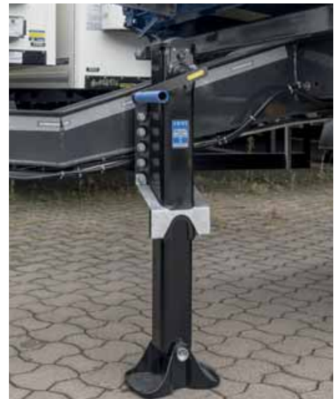
Abb. 7 Stützeinrichtung eines Starr-Deichselanhängers
