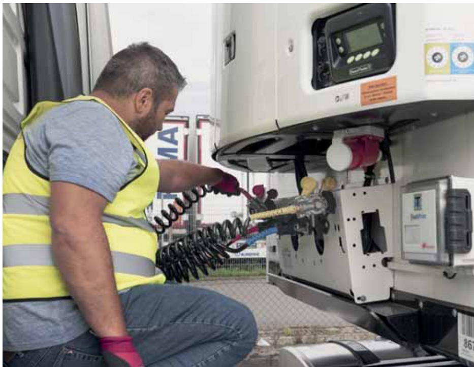
Abb. 25 Anschließen der Verbindungs- leitungen
