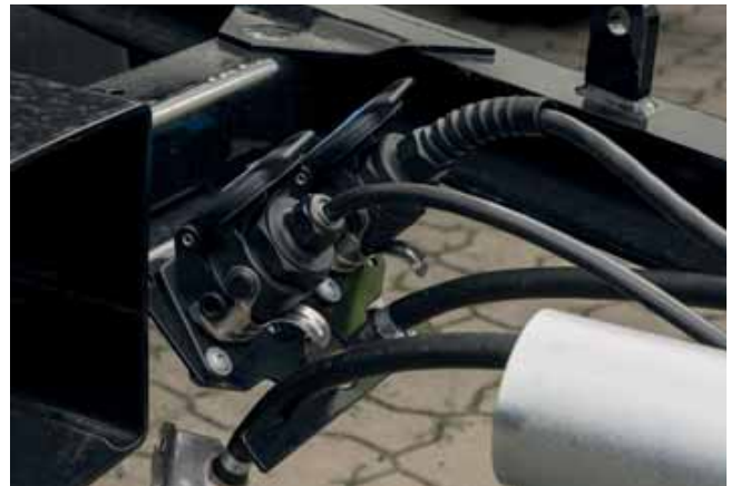
Abb. 20 Verbindungsleitungen in Parkdosen stecken
