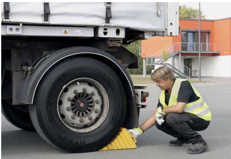
Abb. 11 Anlegen der Unterleg- keile
