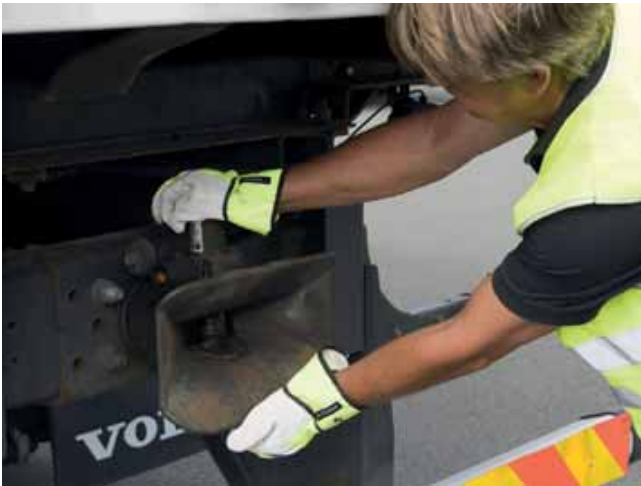
Abb. 36 Prüfen auf Längs- und Höhen-/ Radialspiel
