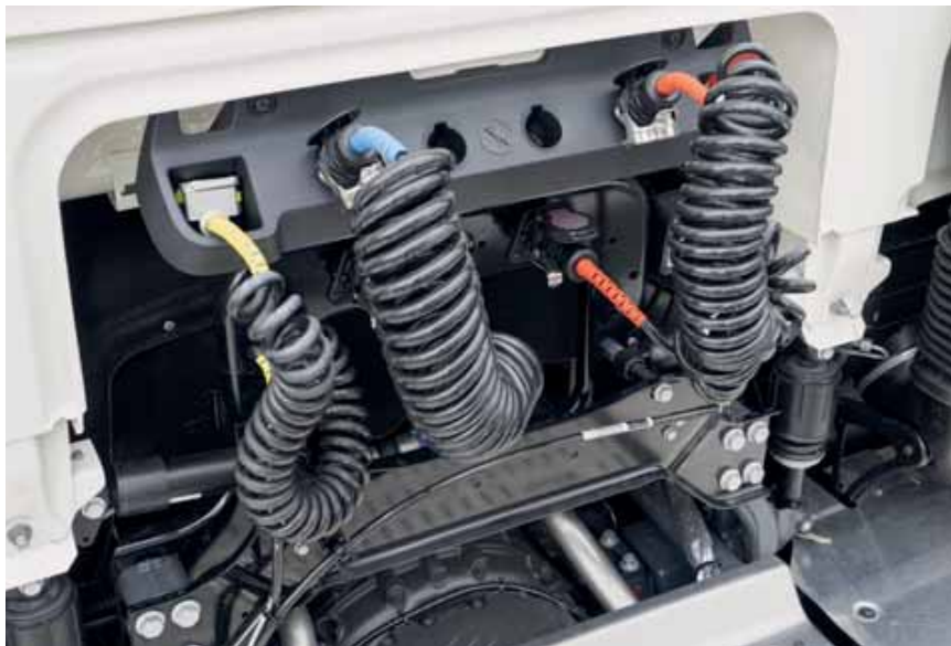
Abb. 30 Unterbringung der Leitungen
