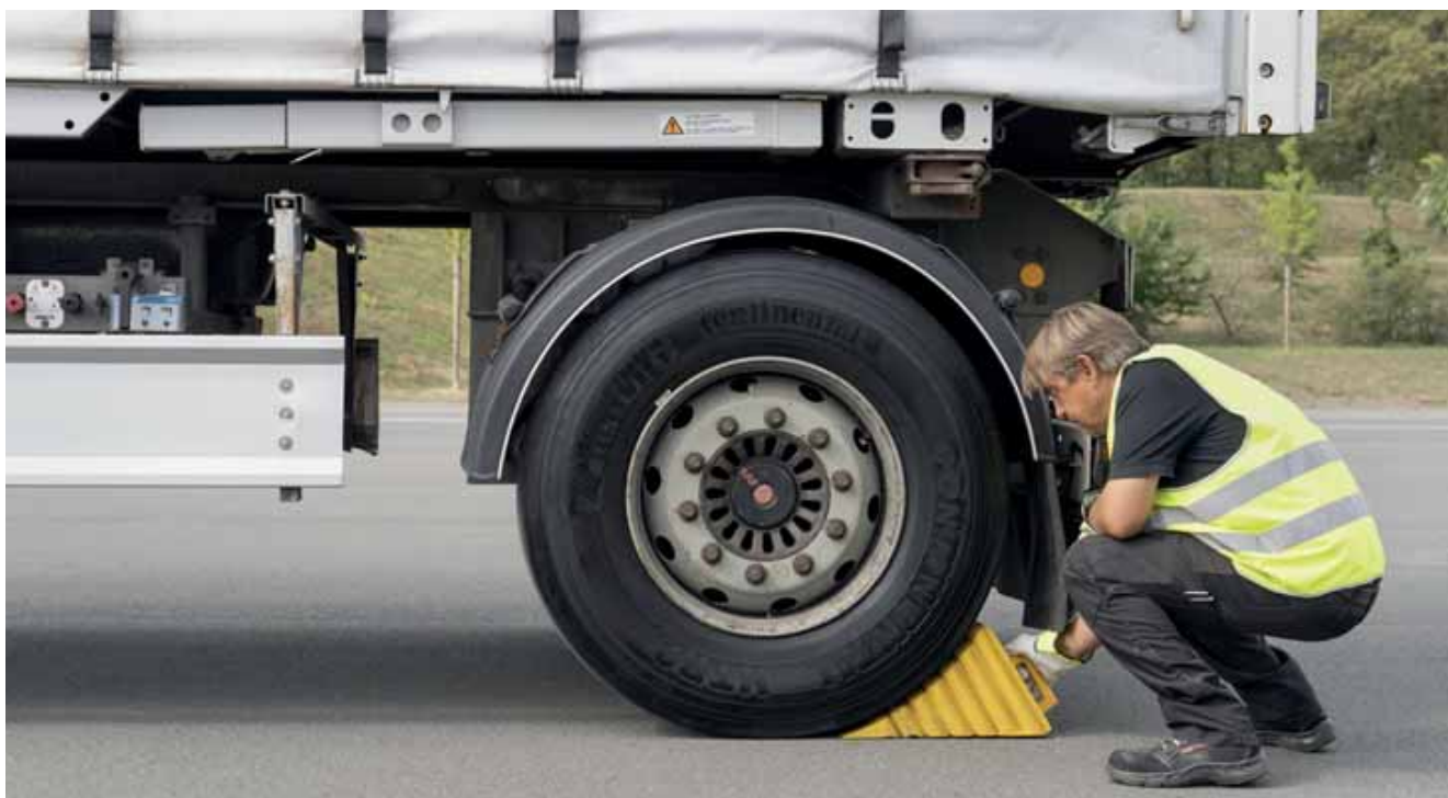
Abb. 18 Anlegen der Unterlegkeile
