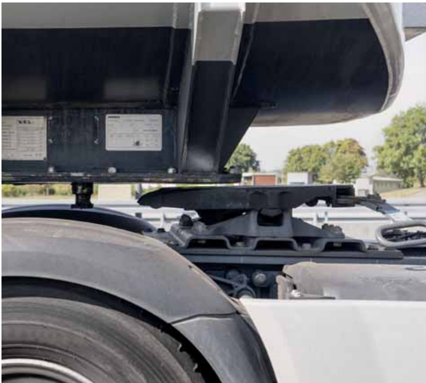
Abb. 22 Luftspalt (max. 5 cm) zwischen Sattelplatte und Aufgleitplatte
