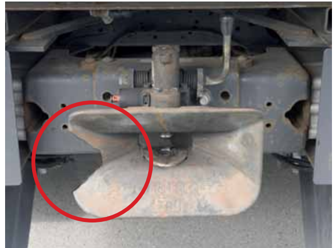
Abb. 37 Fangmaul auf Arretierung und Schäden kontrollieren
