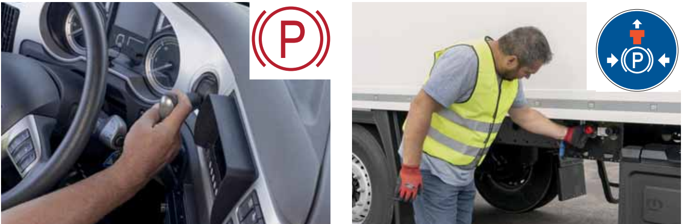
Abb. 28 Betätigen der Feststellbremsen
