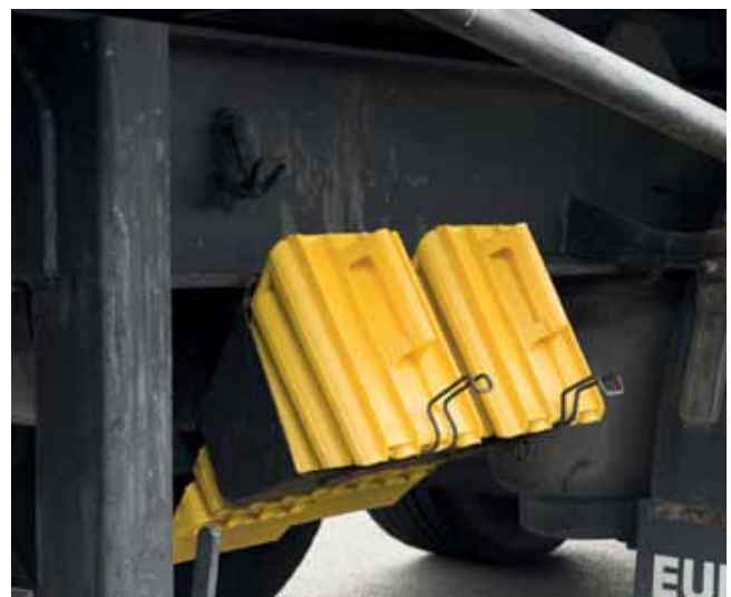
Abb. 33 Möglichst zwei Unterlegkeile je Anhänger
