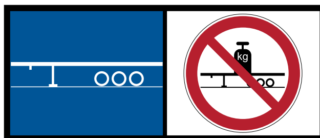
Abb. 9 Kennzeichnung an Sattelstützen geringerer Tragfähigkeit
