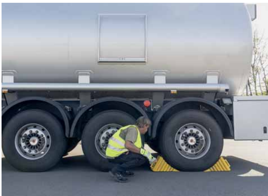
Abb. 29 Anlegen der Unterlegkeile
