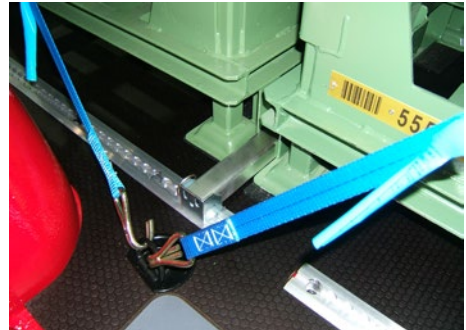
Kombinierte Ladungssicherung im Kastenwagen
