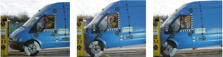
Crashtest eines Kastenwagens
