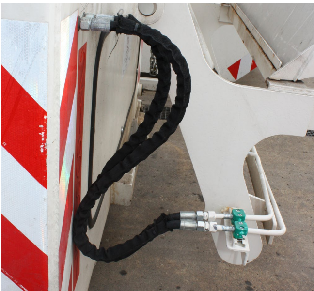
Abb. 23 Berstschauch über Hydraulikleitungen
