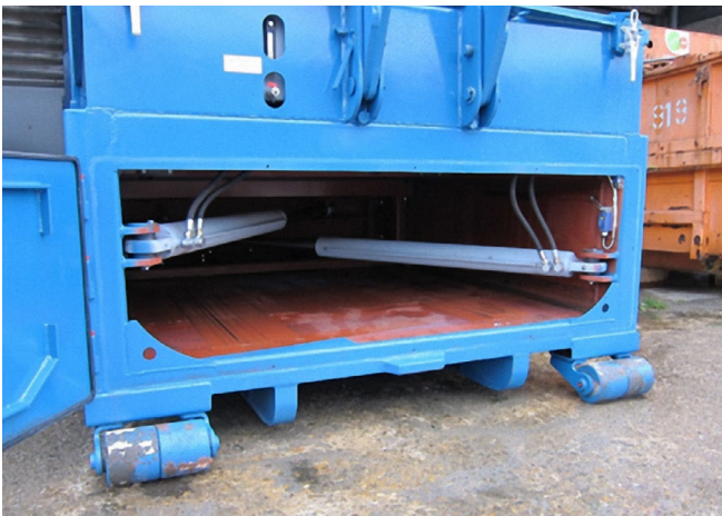
Abb. 10 Wartungs- und Reinigungszugang
