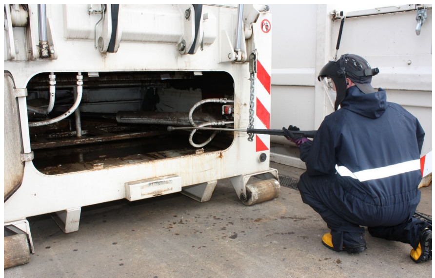
Abb. 12 Reinigung des Arbeitsraums mit Hochdruckwasserstrahl
