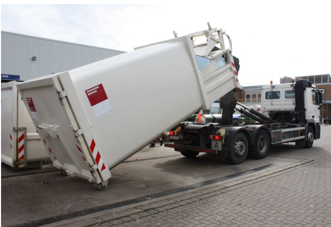
Abb. 2 Mobile Behälterpresse mit horizontalem Pressschild für ein Abrollkipperfahrzeug
