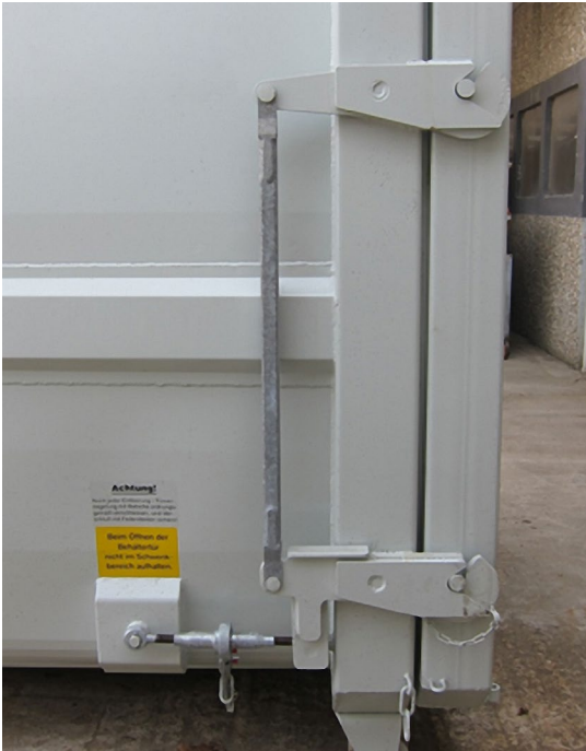
Abb. 25 Verriegelung der Entladungstür
