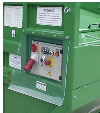
Abb. 19 Spritzschutz durch einen Abweiser
