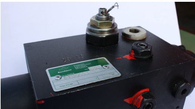
Abb. 22 Druckbegrenzungsventil mit einer Plombe
