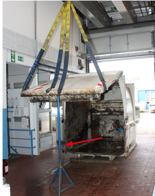
Abb. 27 Sicherung einer angehobenen Entladungstür
