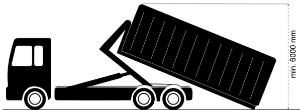
Abb. 37 Rangierhöhenbedarf für Abrollkipper
