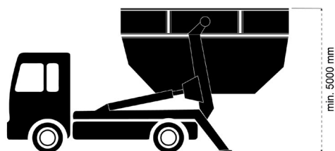
Abb. 38 Rangierhöhenbedarf für Absetzkipper
