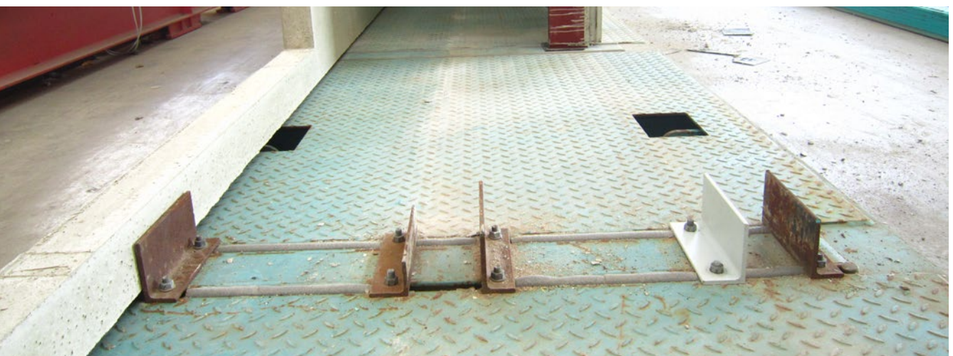
Abb. 23: Beispiel für Abstandhalter im Bodenbereich der IP
