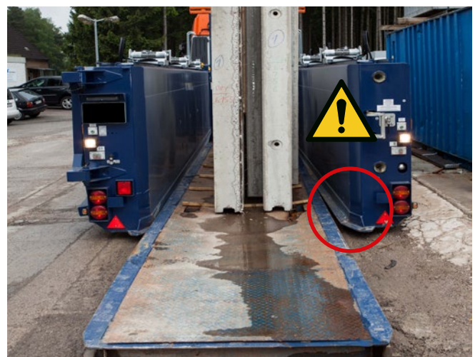
Abb. 24: Scherstelle zwischen IP und Innenlader-Fahrzeug
