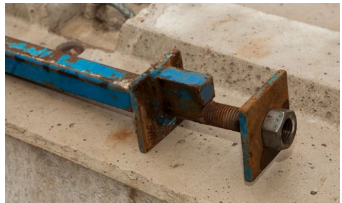
Abb. 20: Schraubarretierung mit zusätzlicher Verdrehsicherung
