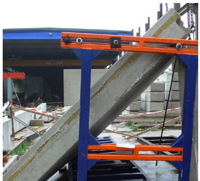
Abb. 11: Umsturz der Last durch Einwirken äußerer Kräfte
