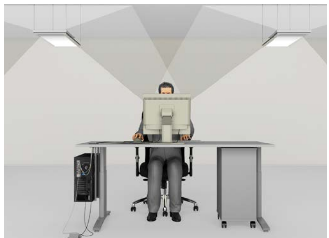
Abb. 45 Beispiel für Direkt-/Indirektbeleuchtung
