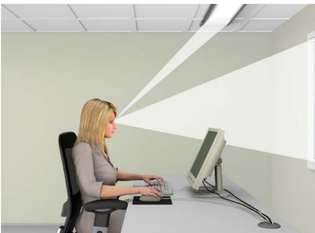
Abb. 42 Direktblendung durch zu große Helligkeitsunterschiede im Blickfeld – zum Beispiel durch Fenster
