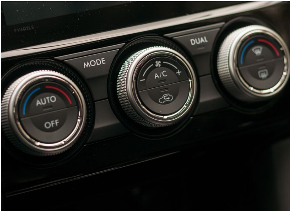
Abb. 8 Bedienelemente einer Klimaanlage
