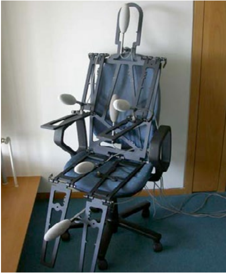
Abb. 4 Messsystem zur Klimabeurteilung an Fahrzeugplätzen
