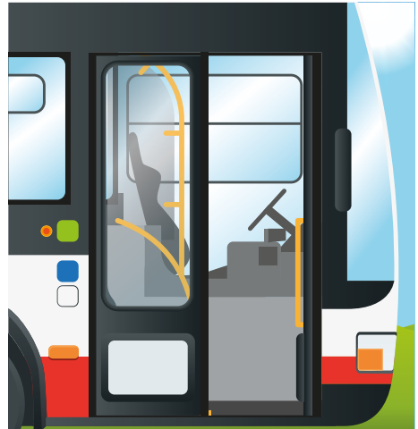
Abb. 10 Türflügelsperre: Nur eine Tür geöffnet
