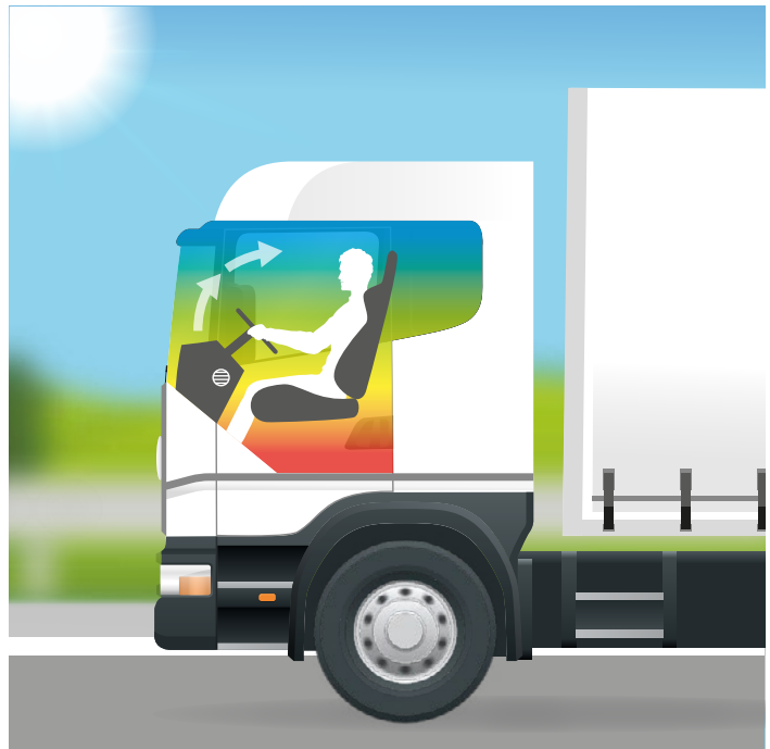
Abb. 13 Luftführung und Temperaturverteilung im Kühlbetrieb
