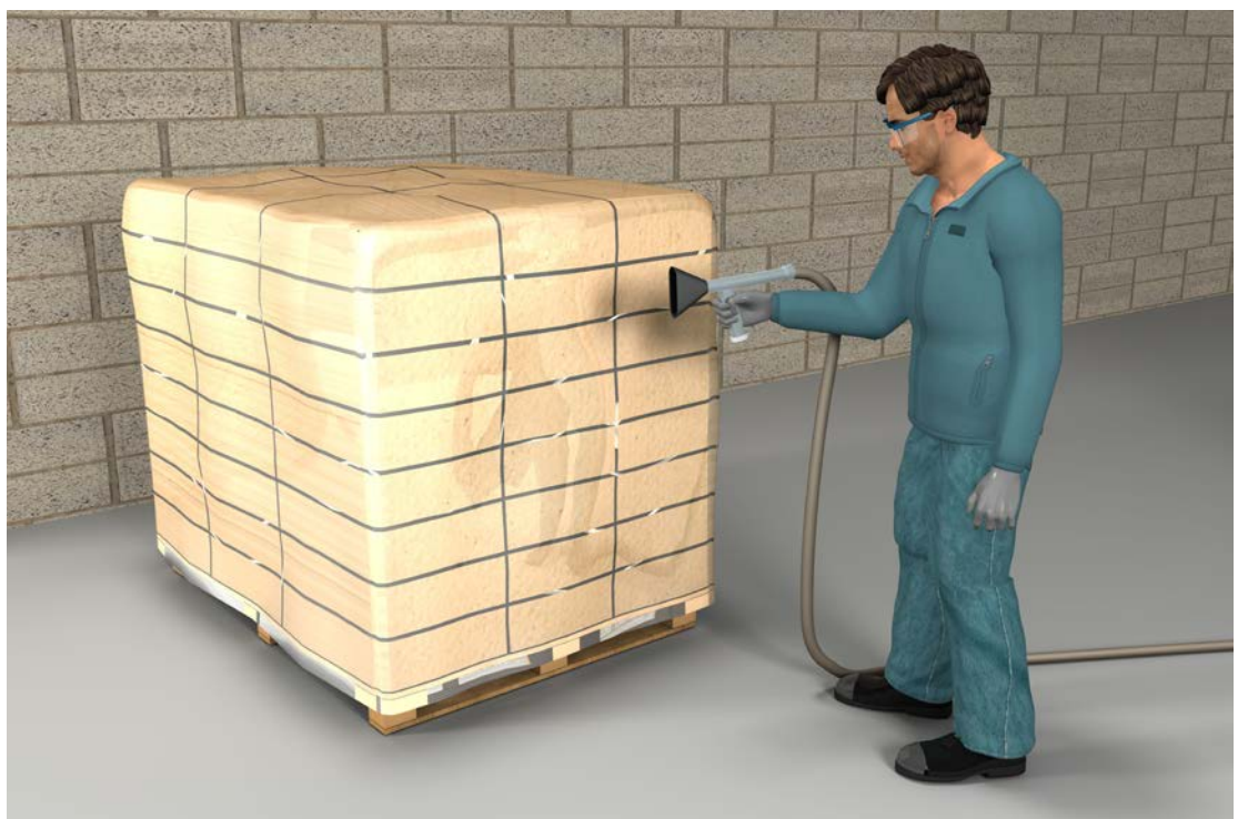
Abb.36 Schrumpfen mittels Handschrumpfgerät
