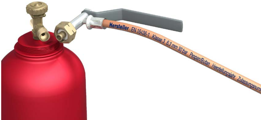
Abb. 27 Schlauchleitung Klasse 3 für maximalen Betriebsdruck 30 bar
