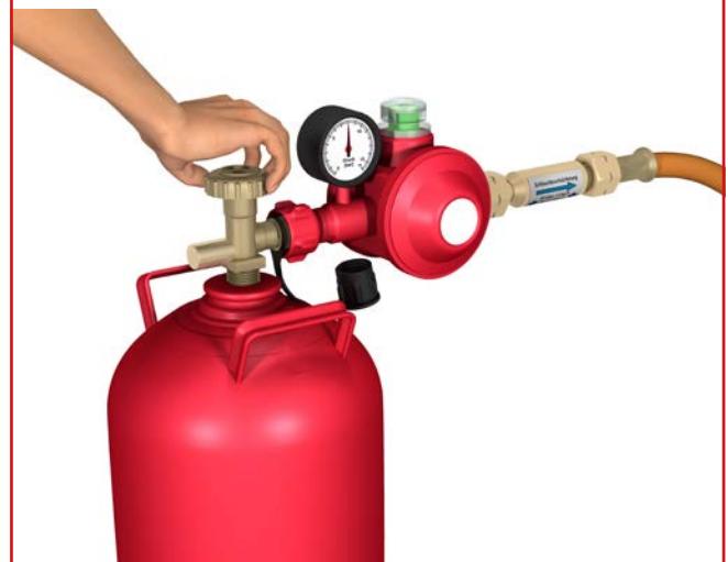
Abb. 30 Zudrehen des Flaschenventils (Flaschenventil = Hauptabsperreinrichtung, Drehrichtung rechts)
