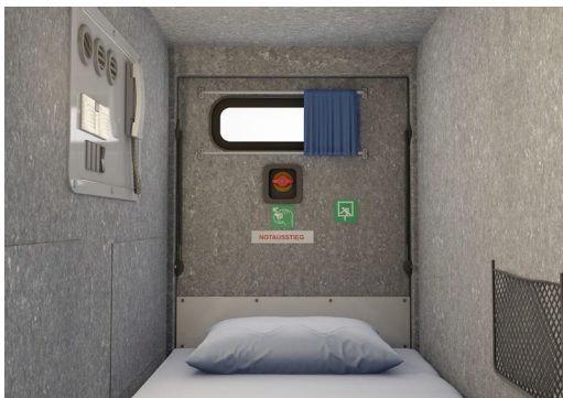
Abb. 13 Notausstieg mit Fenster
