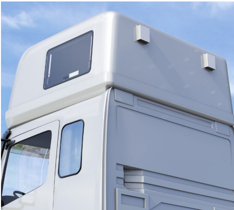
Abb. 8 Sicherheitsbelüftung der Dachschlafkabine
