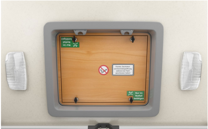
Abb. 3 Durchstiegsöffnung im Fahrerhaus – im Notfall, nach unten zu öffnen
