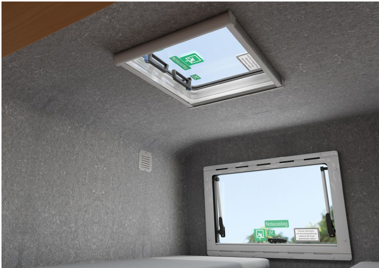
Abb. 10 Zweiter Notausstieg in der Dachfläche
