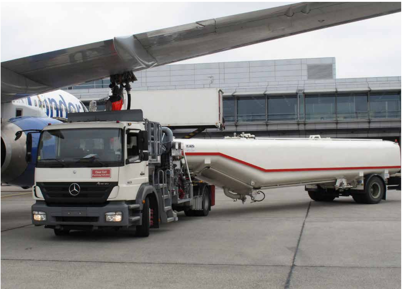
Abb. 82 Betanken eines Luftfahrzeugs mit Tankwagen
