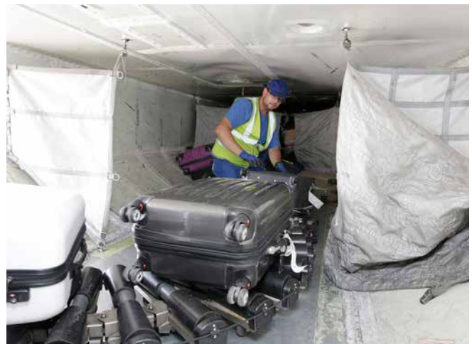
Abb. 51 Verladen mit Ladehilfe
