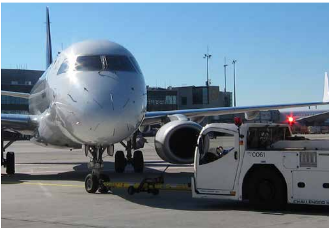
Abb. 96 Pushback mit Schleppstange
