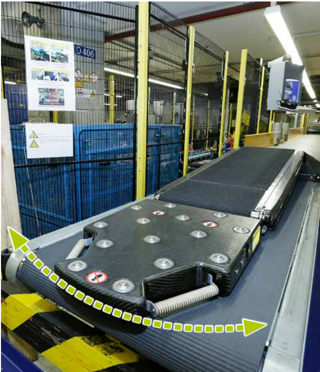
Abb. 66 Ein verstellbarer Ladetisch erleichtert die Gepäckverladung
