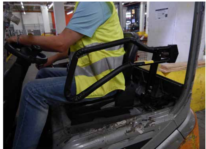
Abb. 71 Rückhalteeinrichtung am Flurförderzeug
