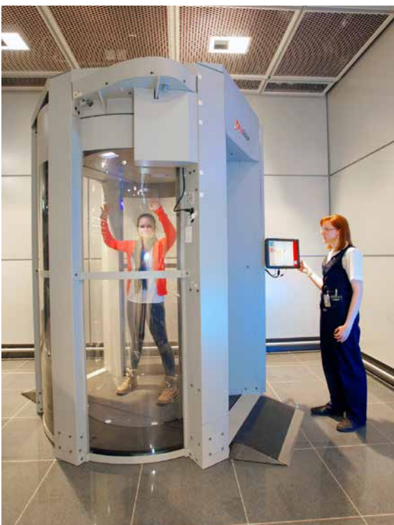
Abb. 107 Ganzkörperscanner im Einsatz
