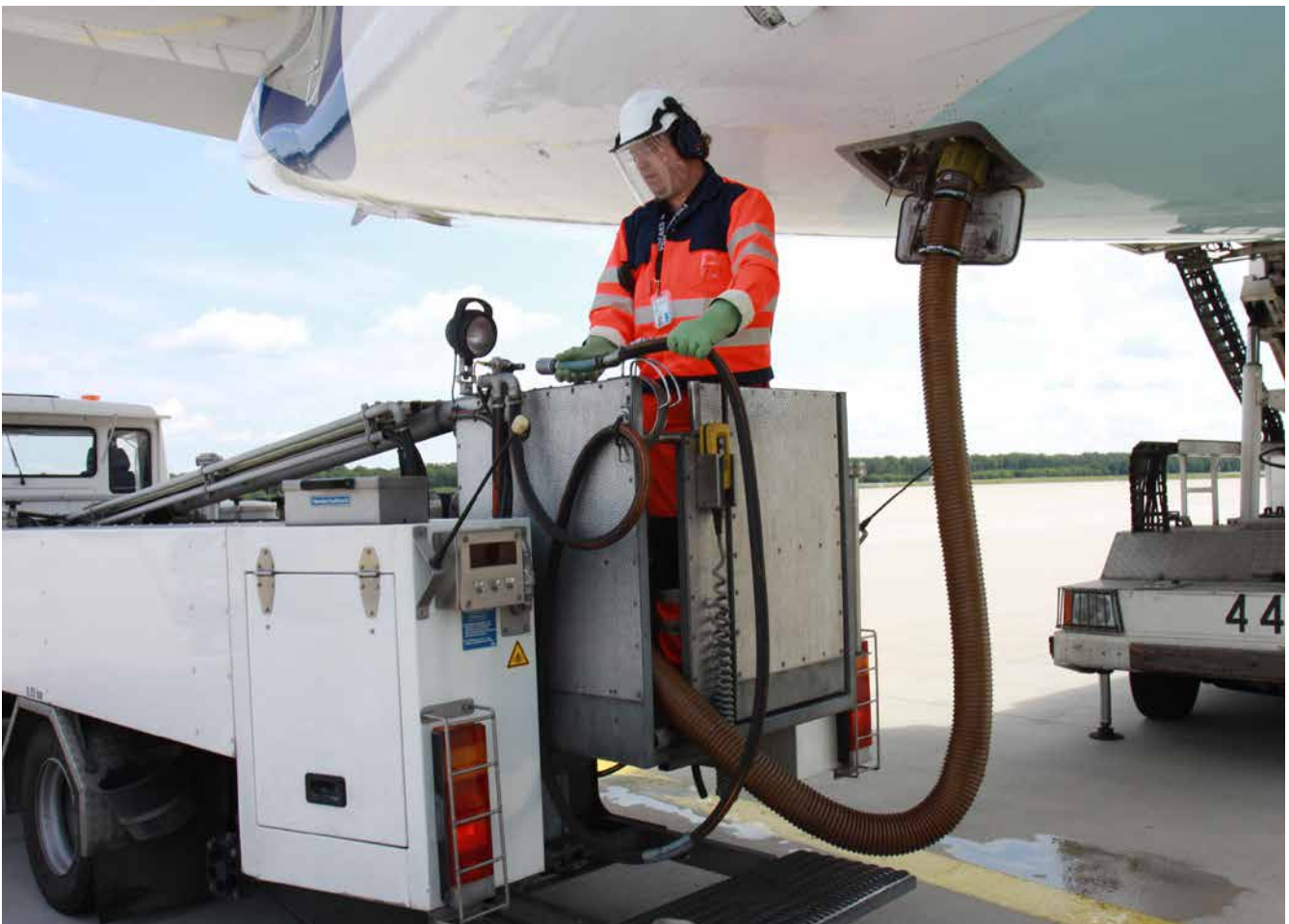
Abb.78 Entleeren des Fäkalientanks an einem Luftfahrzeug
