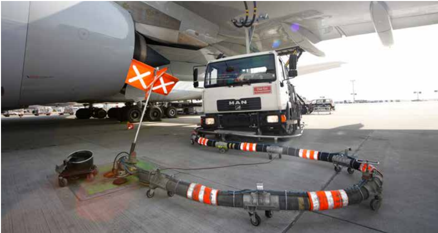
Abb. 84 Betanken eines Luftfahrzeugs mittels Dispenser
