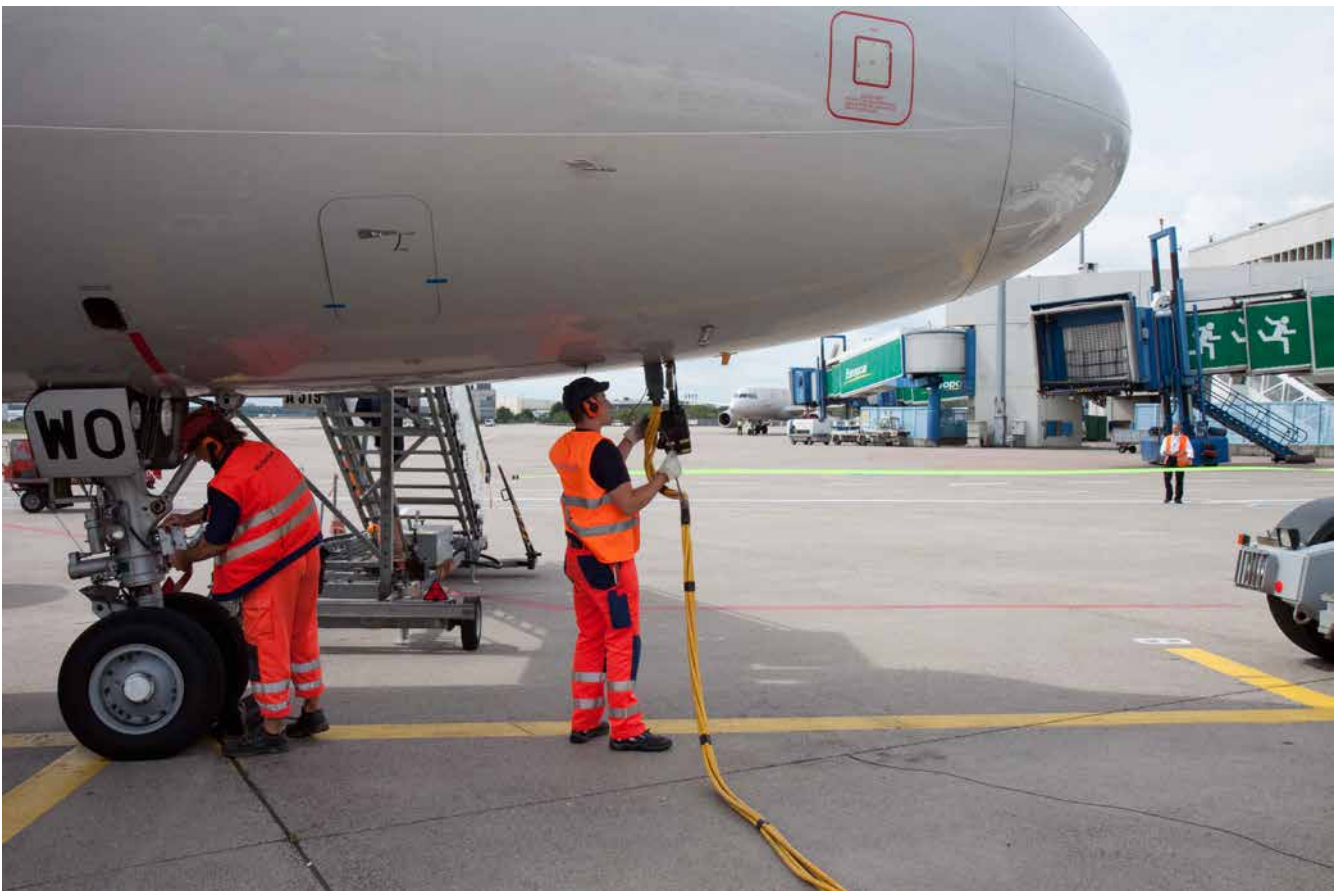
Abb. 31 Anschließen der Ground Power Unit (GPU)
