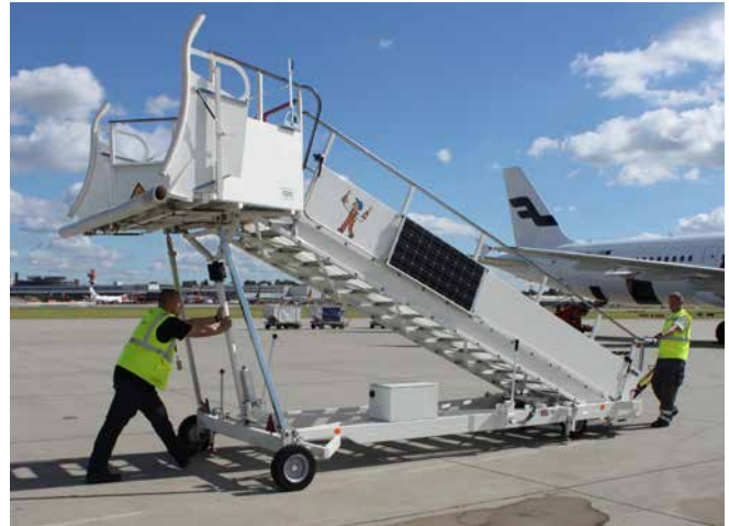
Abb. 40 Manuelles Ziehen und Schieben einer Fluggasttreppe zu zweit
