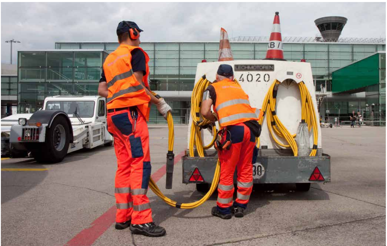
Abb. 35 Ground Power Unit (GPU) mit Kabelhalterung
