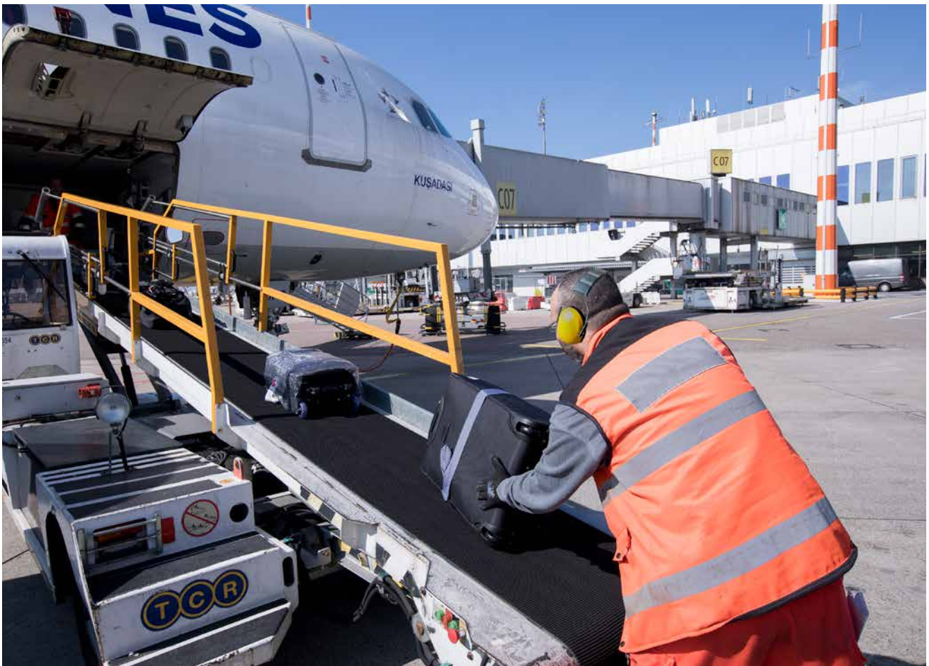
Abb. 50 Be- bzw. Entladen des Frachtraums mittels Förderbandwagen
