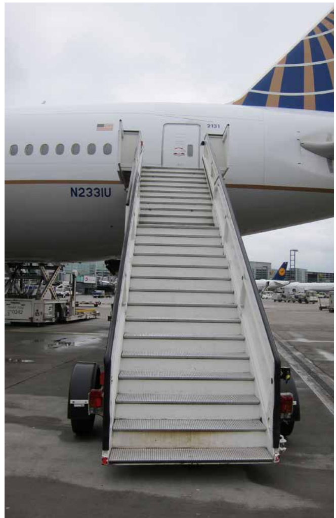
Abb. 41 Am Luftfahrzeug positionierte Fluggasttreppe
