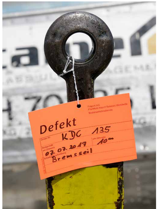
Abb. 60 Kennzeichnung von defekten Arbeitsmitteln
