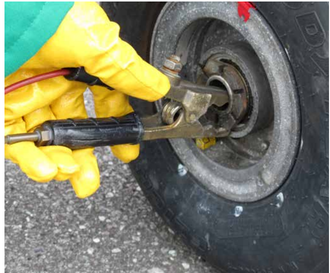
Abb. 83 Anschluss der Potentialausgleichsleitung am Luftfahrzeug
