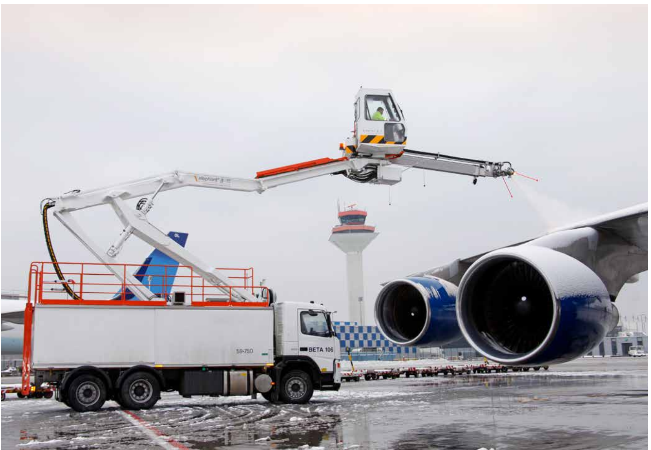
Abb. 86 Enteisung eines Luftfahrzeugs
