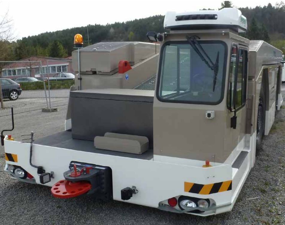
Abb. 98 Flugzeugschlepper mit Klimaanlage
