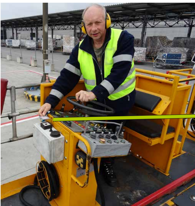
Abb. 72 Elektronische Fahrberechtigung (Easy Key)
