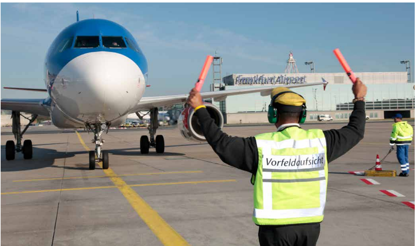
Abb. 28 Einwinken des Luftfahrzeuges auf die Parkposition
