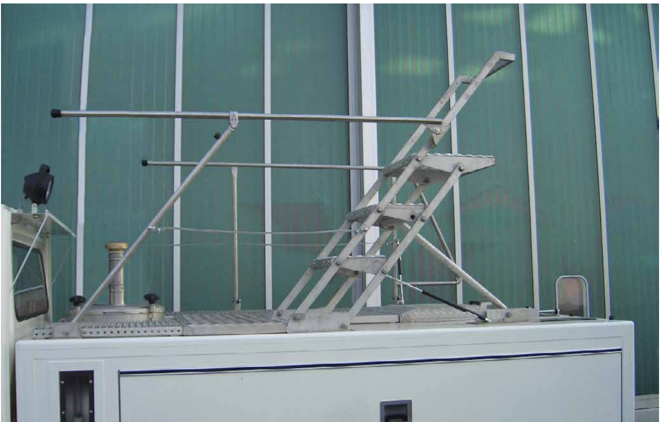
Abb. 79 Absturzsicherung auf einem Servicefahrzeug
