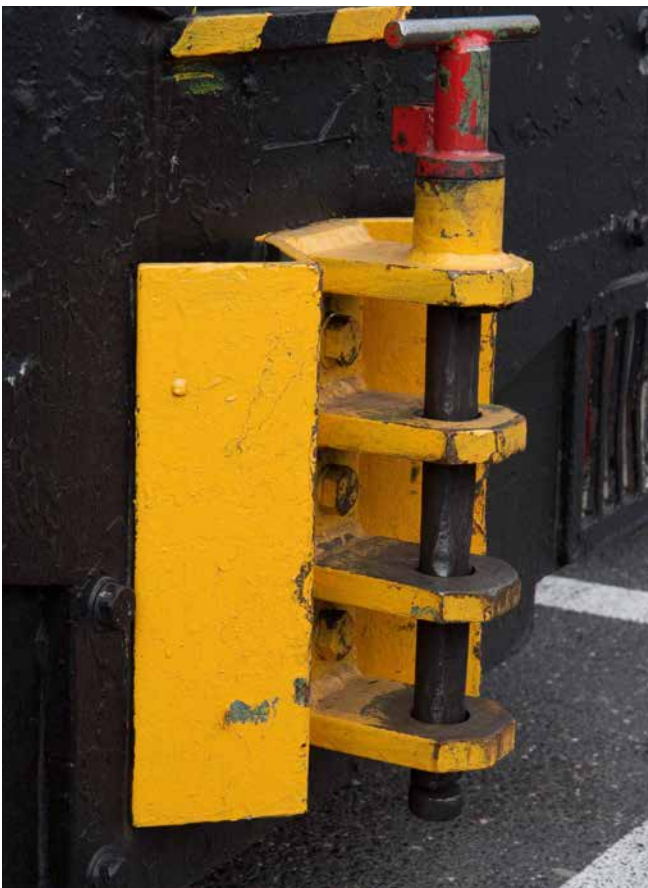
Abb. 59 Aufprallblech an Zugeinrichtung
