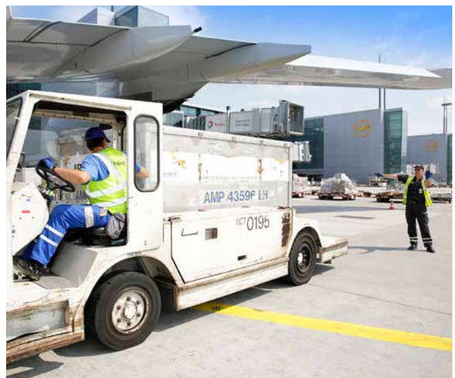
Abb. 64 Einweisen eines Transfergerätes für Paletten
