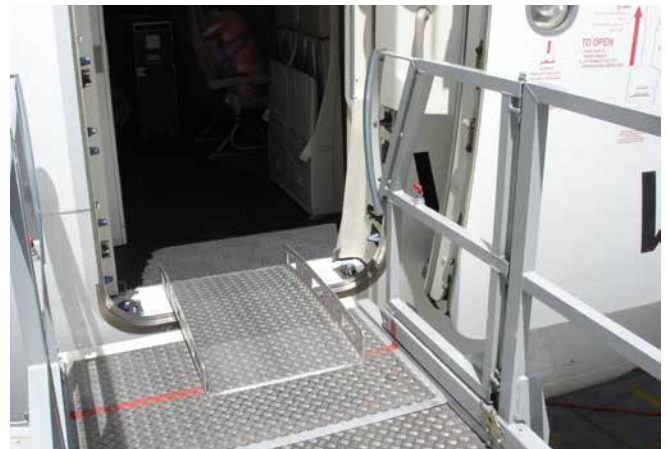
Abb. 75 Zugang zum Luftfahrzeug mit Überladeblech
